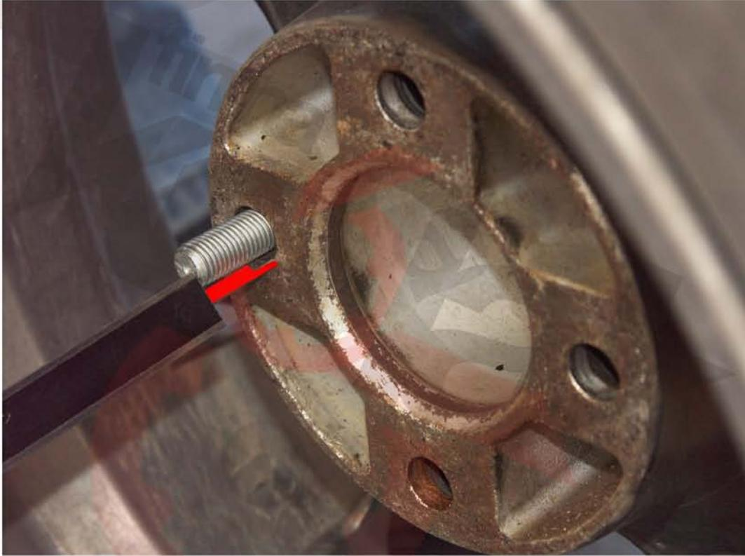
Ostatnim pomiarem jaki w 100 % zapewni Nas w wyborze odpowiedniej długości roboczej gwintu śruby, jest pomiar głębokości otworu w piastach auta.
